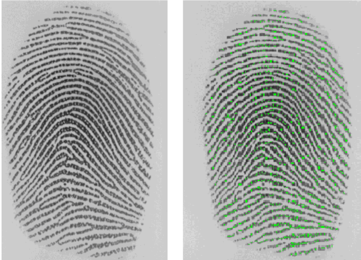
Рис.6. Определение пор алгоритмом k-средних: а) оригинальное изображение; б) выделенные поры отображены зеленым цветом
