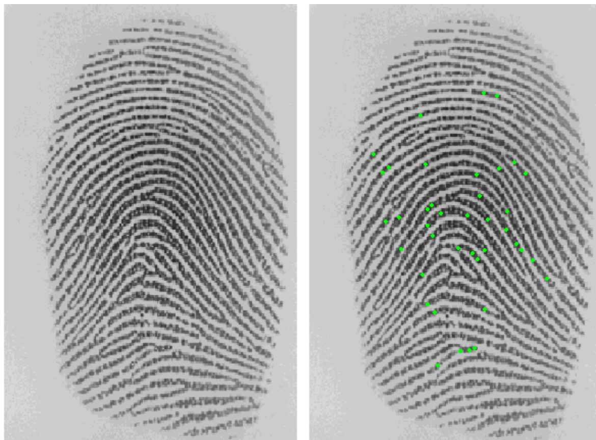
Рис. 8. Определение пор модифицированным алгоритмом k-средних: а) оригинальное изображение; б) выделенные поры отображены зеленым цветом
