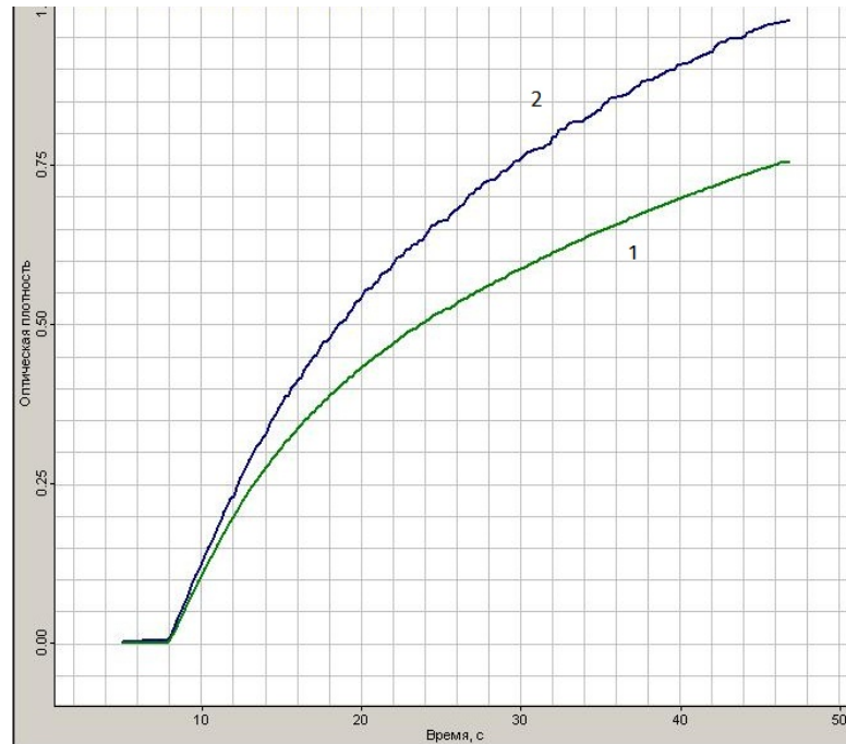
Рис.4. Зависимость интегральной оптической плотности (1) и оптической плотности при длине волны в максимуме поглощения от времени (2) для ЭХУ с 1,1'-бис(пара-цианофенил)-4,4'-бипиридина дихлоридом.
